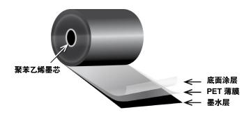
背涂层技术为打印头提供保护, 可防止静电积聚, 同时为打印头提供润滑
